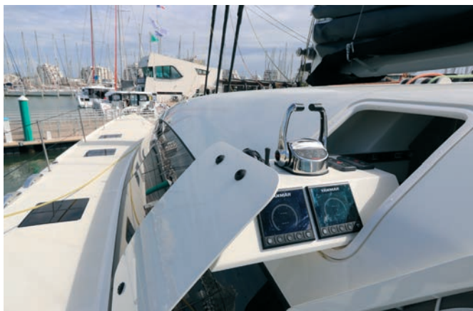
Les commandes moteur s'escamotent dans le rouf ; une belle trouvaille !
