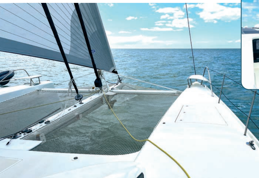
Le plan de pont est épuré au maximum, d'autant que les passavants ne sont pas encombrés par des dérives ; une échelle permet de grimper à l'avant du rouf.
