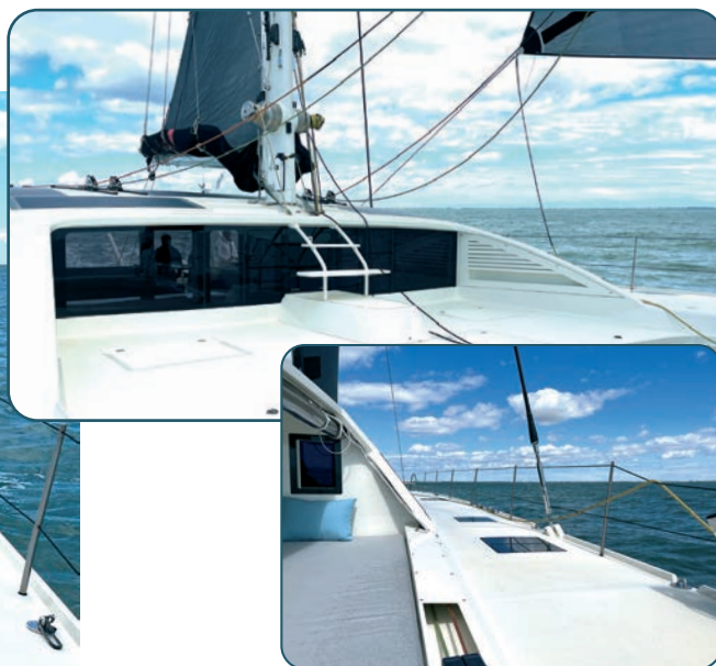
Le plan de pont est épuré au maximum, d'autant que les passavants ne sont pas encombrés par des dérives ; une échelle permet de grimper à l'avant du rouf.
